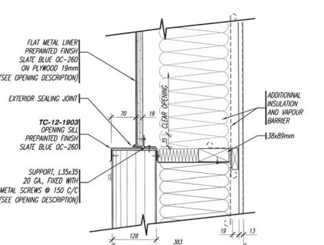
107.9 **SILL ASSEMBLY FOR SPANDEL PANEL** SCALE 1:5
