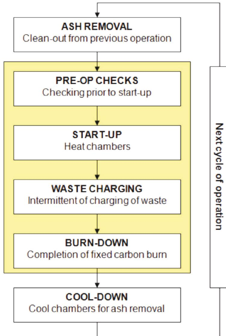
**FIGURE 9 STEPS IN THE OPERATION OF THE INCINERATOR**
